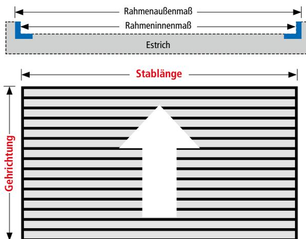
Die Eingangsmatte wird möglichst in einem Stück hergestellt. Größen, die in Abmessung und Gewicht zu unhandlich werden, müssen geteilt werden. **Maximale Länge und maximales Gewicht zur Herstellung ohne Teilung: Länge Aluprofile 300 cm, maximales Gewicht 40 kg.**
